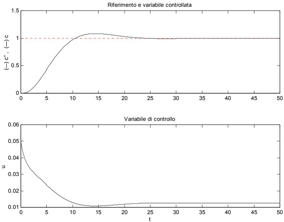
Controllore  $R_{ZM}(s)$  : risposta a scalino di  $c^\circ$
