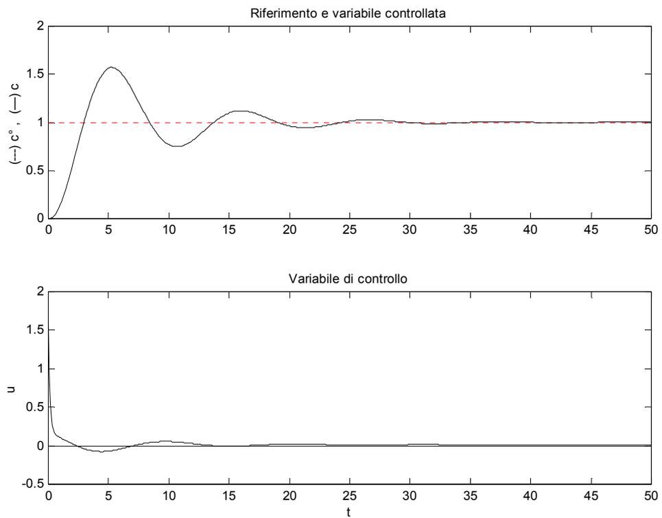
Controllore *PID* con taratura di Ziegler e Nichols, ma con il riferimento escluso dall'azione derivativa (assetto “a derivazione dell'uscita”): risposta a scalino di  $c^0$
