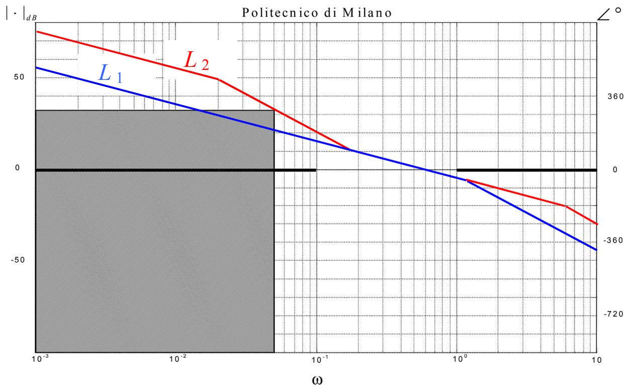
Per aumentare il margine di fase, possiamo ampliare la zona in cui il diagramma ha pendenza  $-1$  attorno alla pulsazione critica. Ciò comporta una modifica del diagramma anche in alta frequenza (linea rossa). In questo modo si ha:
