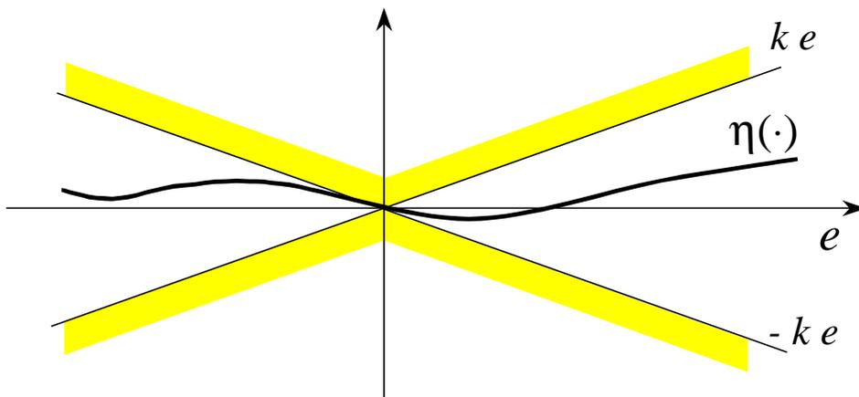
Il sistema  $S^*$  è  $L_2$ -stabile per ogni  $\eta(\cdot)$  nel settore  $[-k, k]$  se  $F(s)$  descrive un sistema asintoticamente stabile e
