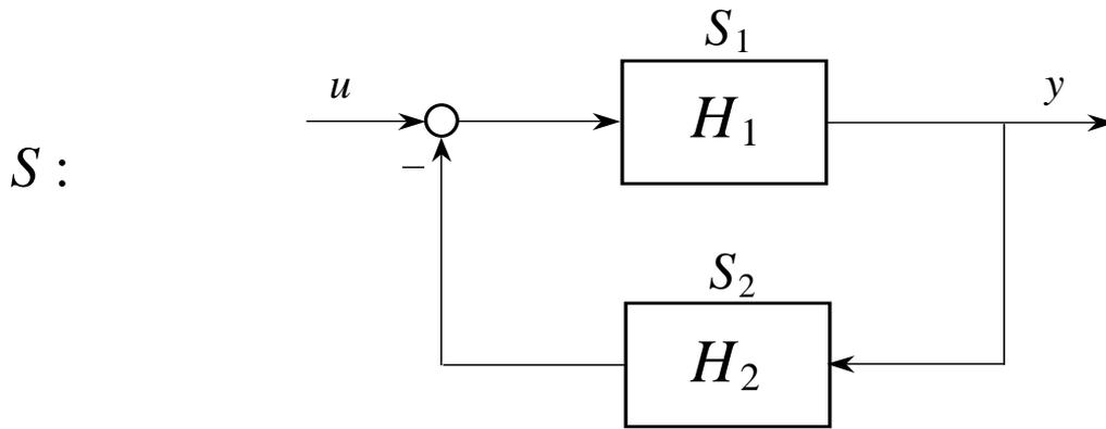
$S_1 :$  Sistema lineare, tempo-invariante, asintoticamente stabile, dinamico in senso proprio, con funzione di trasferimento  $G(s)$ .
