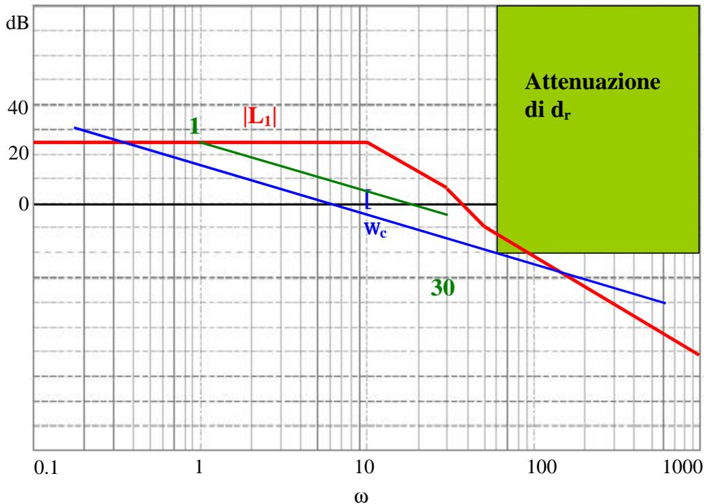
Adesso occorre raccordare  $L$  a  $L_1$  in alta frequenza. Per far ciò si può tracciare un tratto a pendenza  $-3$  da  $\omega=30$  a  $\omega=80$ , e poi uno a pendenza  $-1$  fino a “reincontrare”  $L_1$ , il che si vede avvenire circa a  $\omega=400$ . I tratti in questione sono indicati in blu nella figura.
