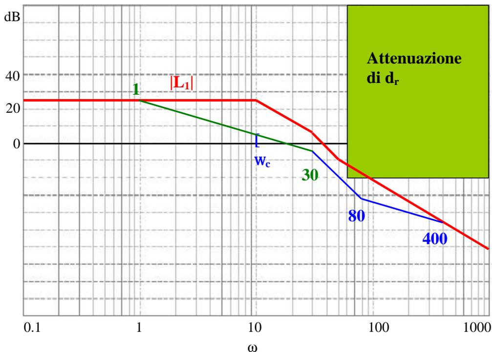
Infine bisogna verificare il margine di fase. Per farlo si pone la freccia dei 45° del regolo delle fasi in corrispondenza della  $\omega_c$  ottenuta (che è circa 15) e si ottengono le letture indicate in nero nella figura.
