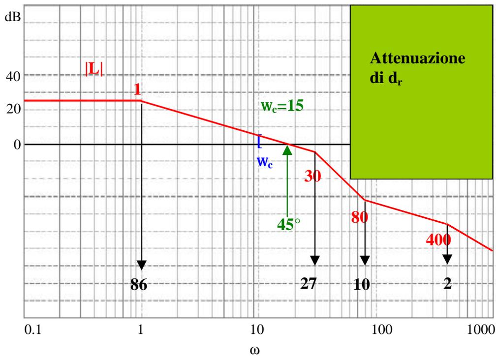
Risulta pertanto  $\varphi_c = -86^\circ - 2 \times 27^\circ + 2 \times 10^\circ - 2^\circ = -122^\circ$ , e dunque  $\varphi_m = 58^\circ$ . Dall'ultimo diagramma di Bode si può anche "leggere"  $L(s)$ , e risulta
